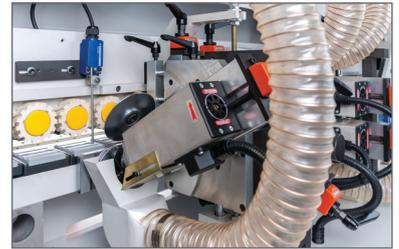
Das pneumatisch getaktete **Profilziehklingenaggregat** bearbeitet die zuvor gefräste Kante. Der ziehende Schnitt entfernt dabei die Hobelschläge und sorgt so für eine gleichmäßige Oberfläche der Kunststoffkanten.
