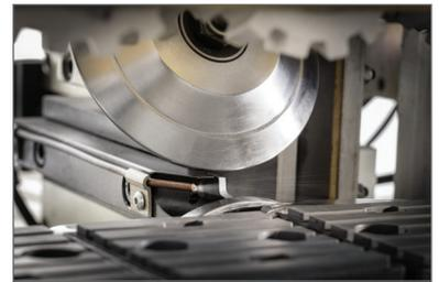
Das ebenfalls pneumatisch getaktete **Flächenziehklingenaggregat** in robuster Ausführung mit separater Absaugung entfernt selbst letzte Klebereste rückstandslos.
