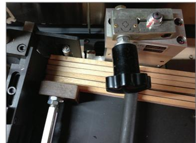
Hochwertige Linearsysteme führen die schrägstellbaren **Trimmaggregate** (2,5 kW, Verstellung 0-15°) und garantieren Präzision, Langlebigkeit und absolut bündig abgekappete Kanten.
