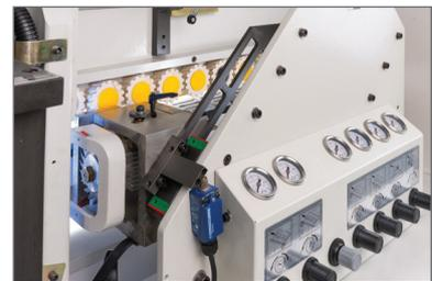
Das **Vorfräsaggregat** hat die Aufgabe, das überstehende, angeleimte Kantenmaterial abzunehmen. Das Kantenmaterial kann entweder bündig mit den Plattenflächen gefräst, oder mit leichtem Überstand für die Nachbearbeitungen belassen werden.
