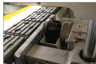
Für Fasen und Rundungen steht ein **Feinfräsaggregat** zur Verfügung. Die Feineinstellungen können manuell über digitale Anzeigen festgelegt werden. Eine Absaugung verhindert Spanschläge.
